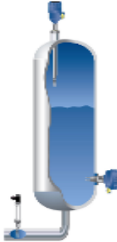
Ilustración 6. Colocación de sensores de horquillas vibrantes en un tanque.
