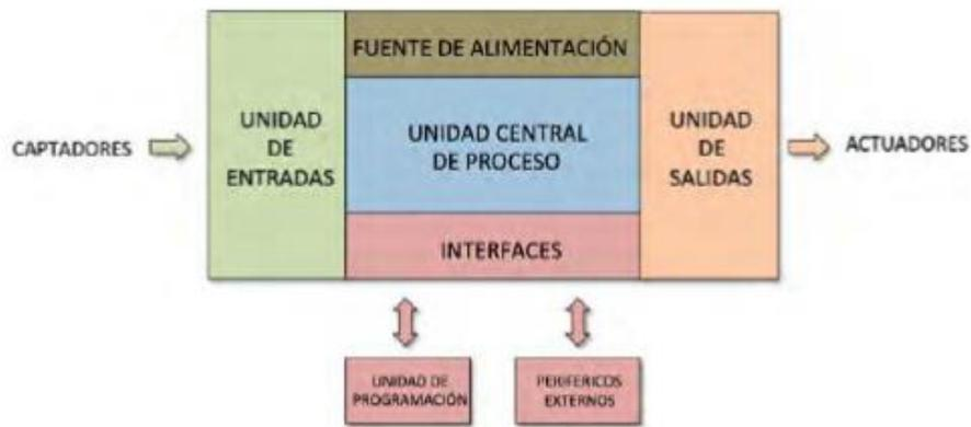
**Ilustración 21. Componentes básicos de un PLC**
