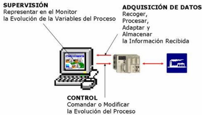
**Ilustración 9. Funciones de un sistema SCADA**
