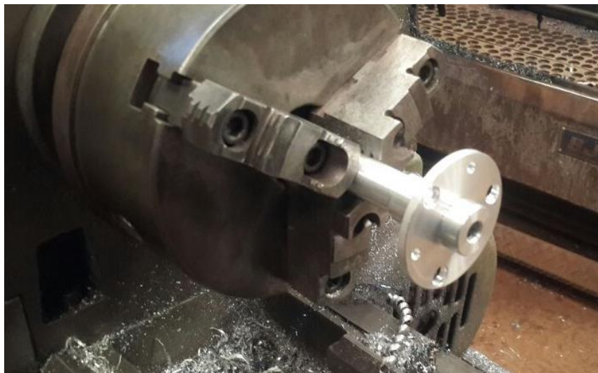
Ilustración 42 - Acople de aluminio para llantas tipo Mecanum a 8mm.
