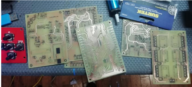
Ilustración 49 - Transferencia de máscara indicadora de componentes electrónicos.
