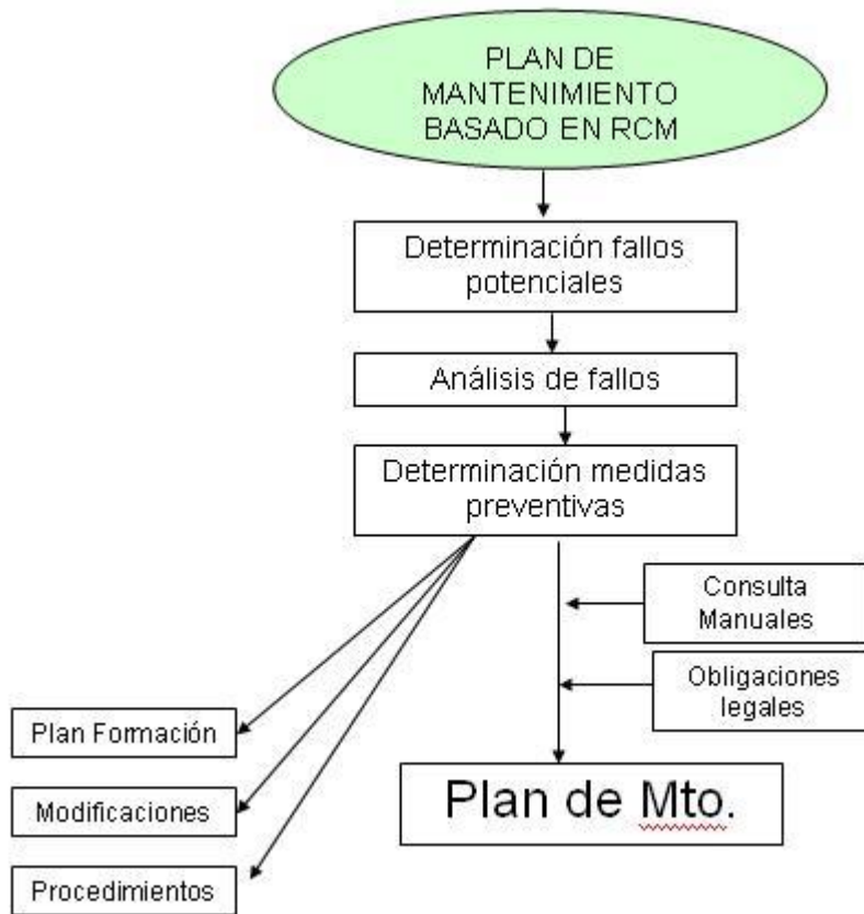
Ilustración 24. Estructura del RCM
