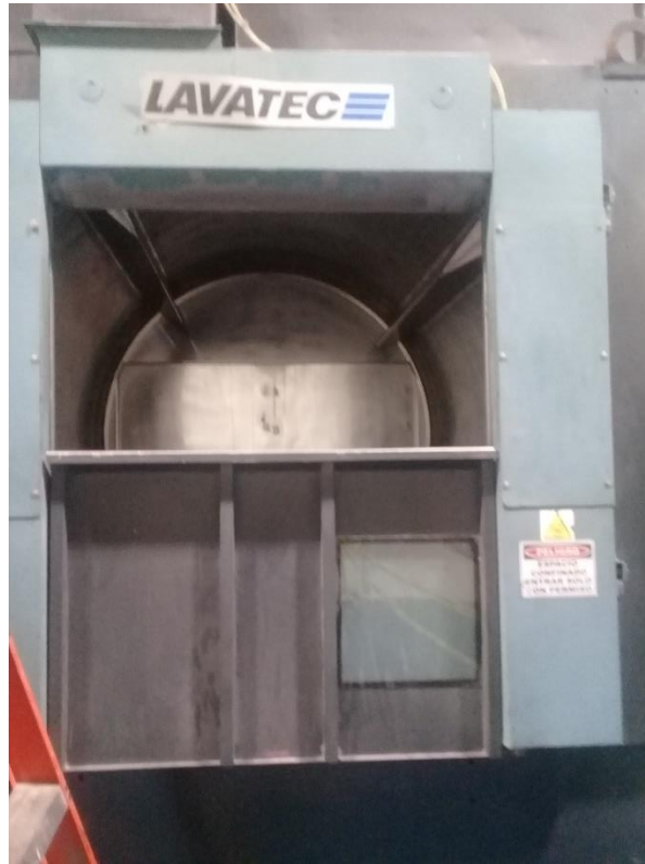
Ilustración 50. Compuerta de Entrada
