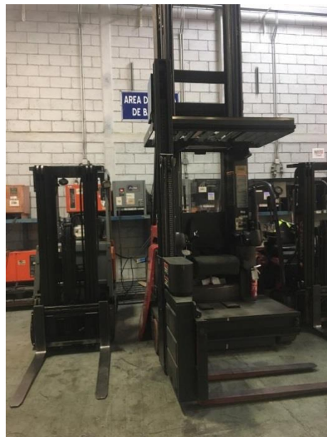
Ilustración 11-Montacargas eléctricos Toyota, maquinaria usada en VFI.
