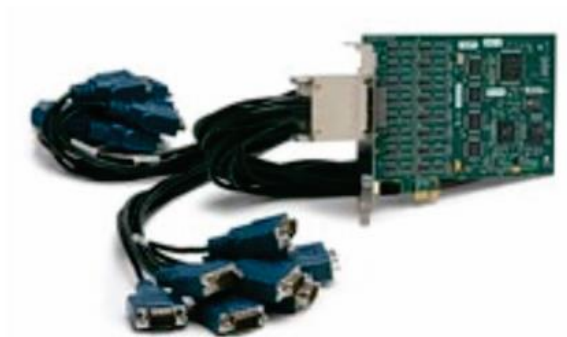
Ilustración 9. INTERFAZ RS-485 DE 16 PUERTOS DE ALTO RENDIMIENTO
