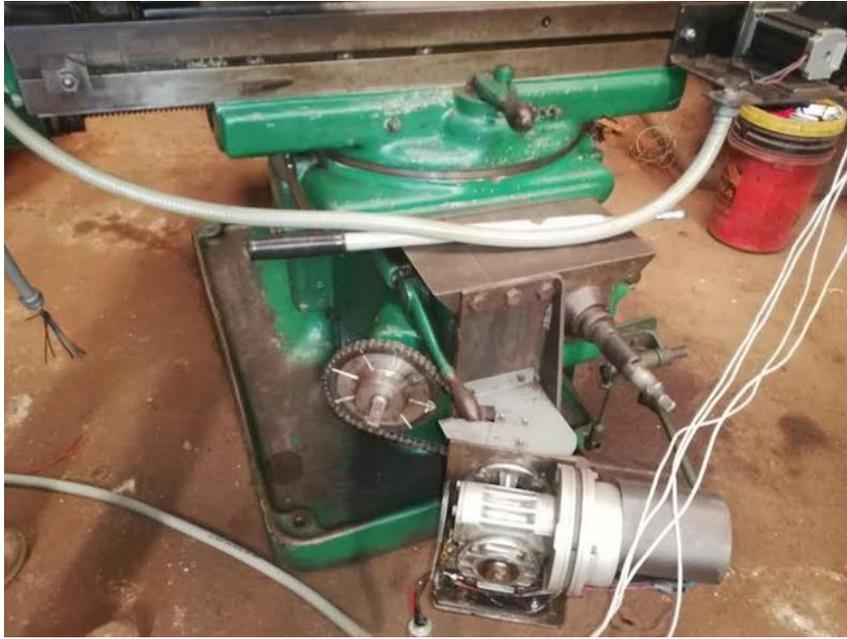
**Anexo 3 - Motor a paso instalado en eje Z.**
