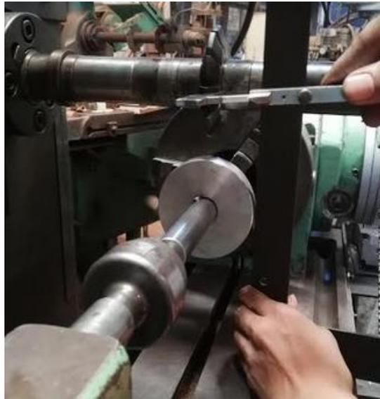
**Ilustración 22 - Alineación de la fresa.**
