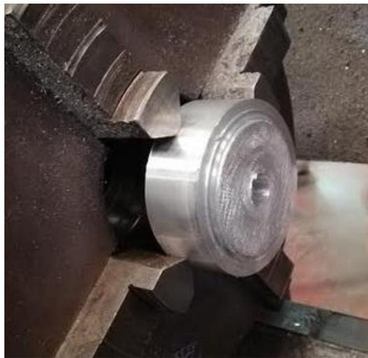
**Ilustración 20 - Elaboración del módulo para creación de engranaje.**
