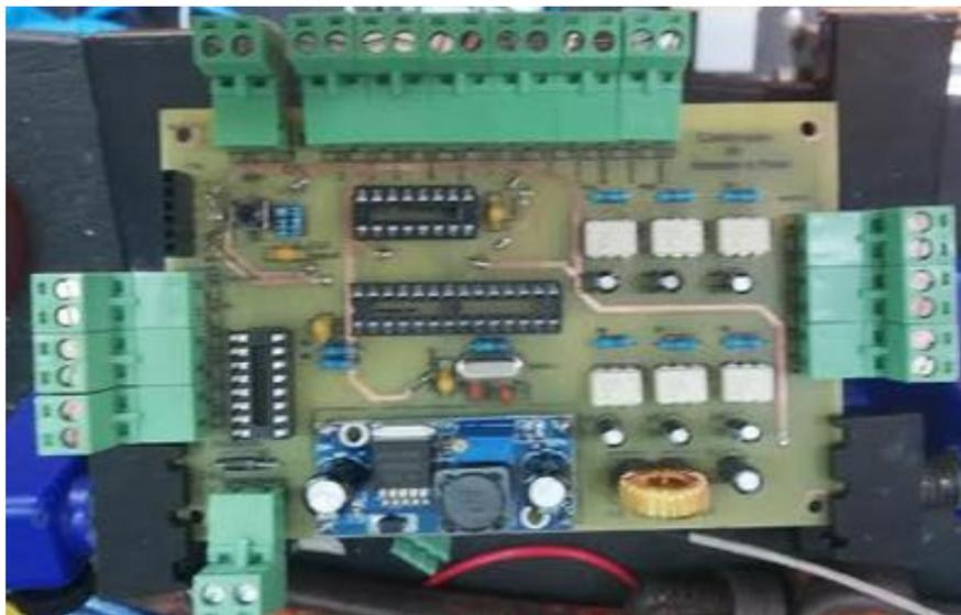
**Ilustración 15 - Placa de circuito electrónico principal finalizado.**
