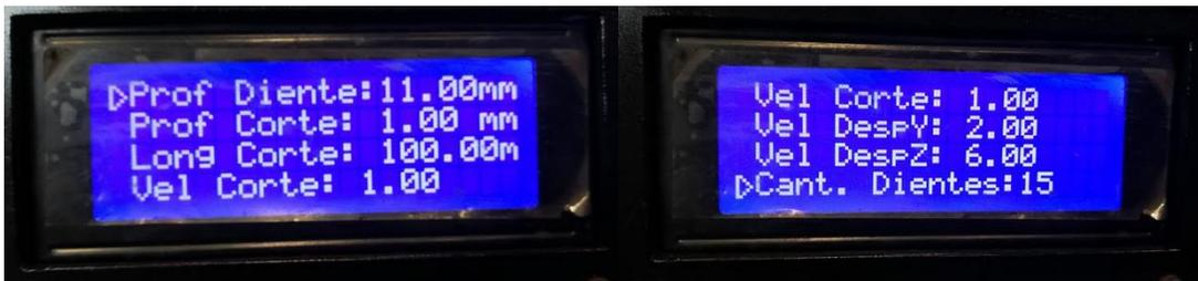
**Ilustración 23 - Calibración de parámetros para el fresado CNC.**
