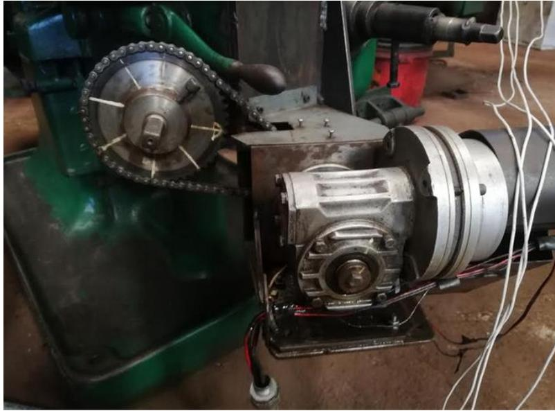
**Anexo 5 - Transmisión de potencia con cadena, eje Z.**
