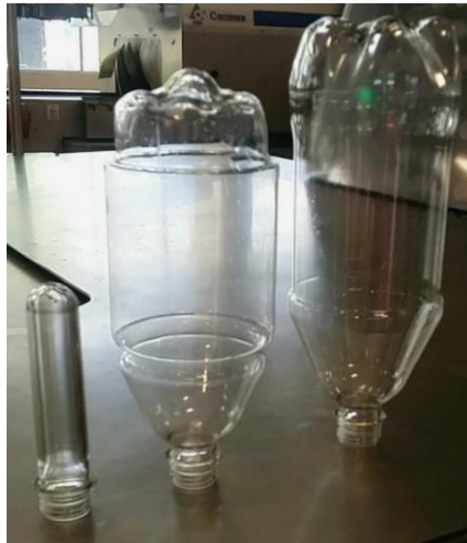
Ilustración 10: Preforma, presoplado y soplado
