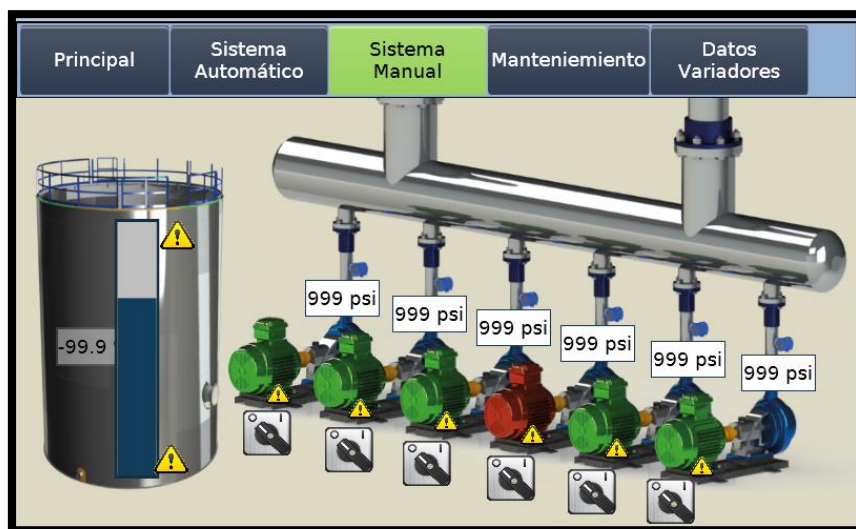
Ilustración 18. Control y Monitoreo de Sistema Manual
