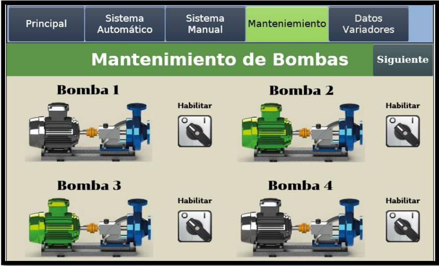
Ilustración 21. Pantalla habilitación de bombas
