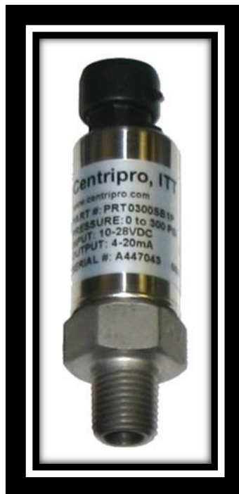
Ilustración 19. Sensor de presión centripro, rango de medición 0-300 psi
