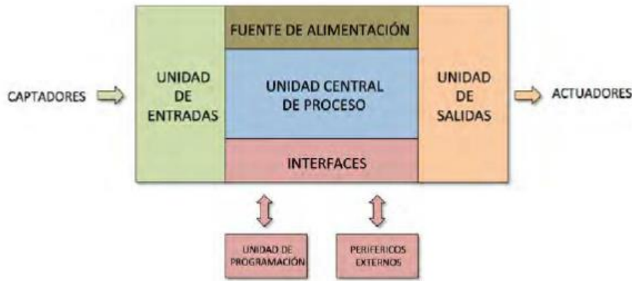
Ilustración 12. Arquitectura básica de un PLC
