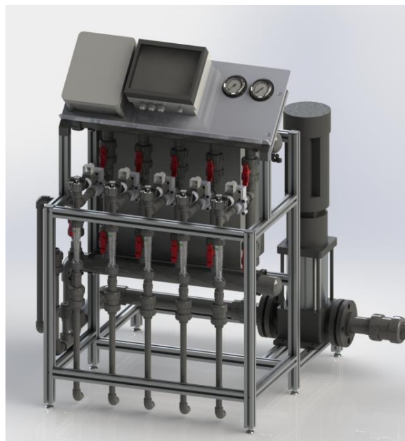
Anexo 4. Prototipo número uno con vista de la ubicación de la bomba y sus componentes en la placa principal.
