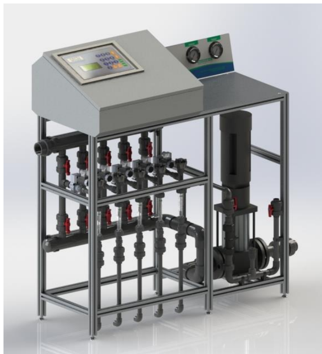
Anexo 8. Prototipo número 3 con la bomba ubicada al lado izquierdo de la estructura.
