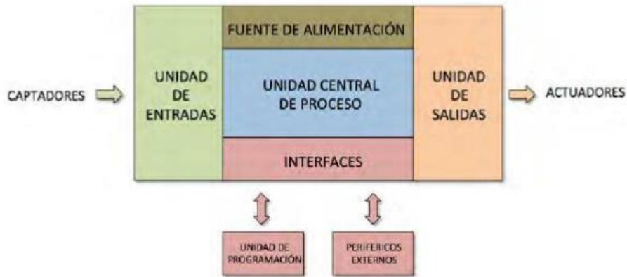
Ilustración3. Arquitectura básica de un PLC
