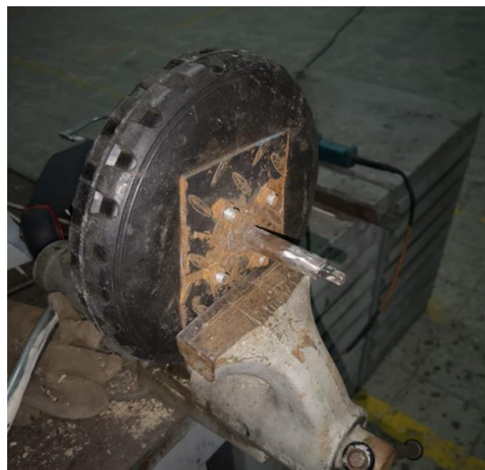
Figura 21- Llanta con eje mecanizado
