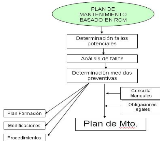
Ilustración 6. Diagrama de flujo basado en análisis de fallo
