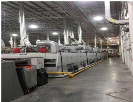
Ilustración 7. Maquina Secadora (Tenter)
