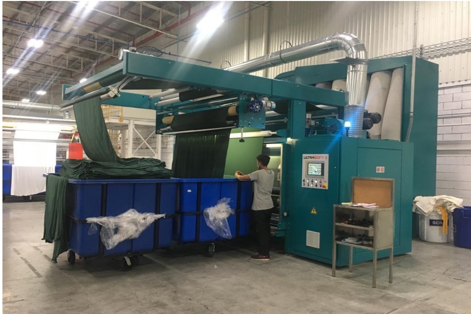
Ilustración 12. Máquina Brushing LAFER
