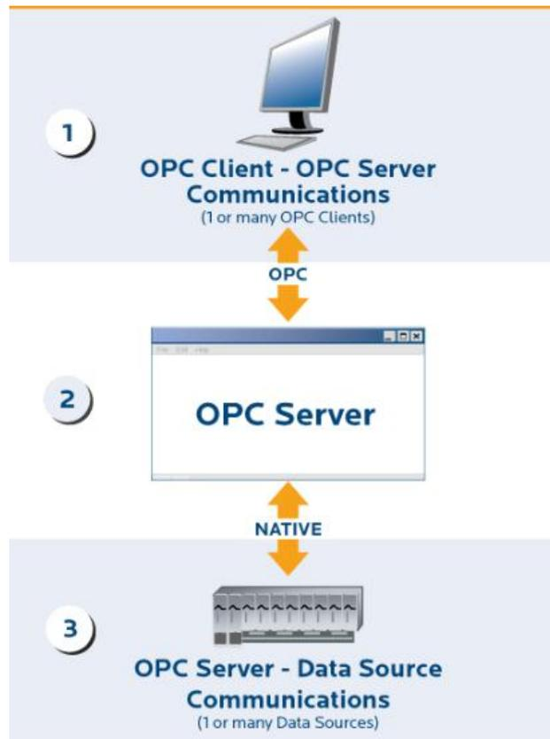
**Ilustración 8-Diagrama del flujo de información en un protocolo OPC**
