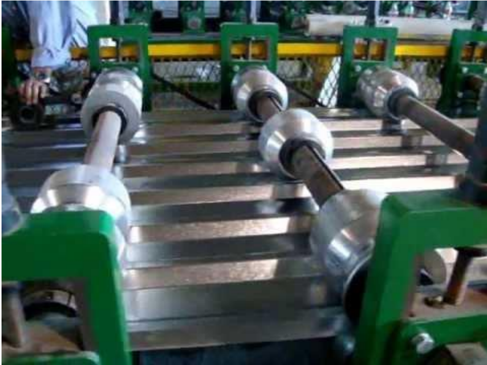
Ilustración 3. Rodillos que dan la forma ondulada a la lámina
