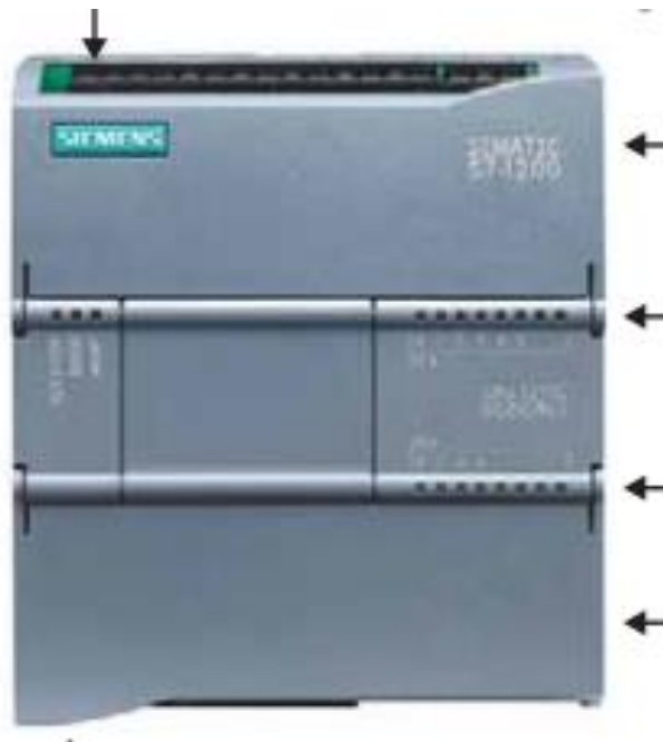
Ilustración 12. PLC S7-1200 utilizado en la automatización
