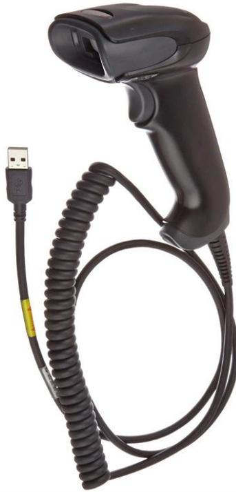
**Ilustración 16. escáner laser de códigos**
