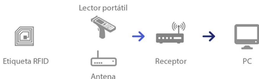
**Ilustración 8. Sistema RFID**
