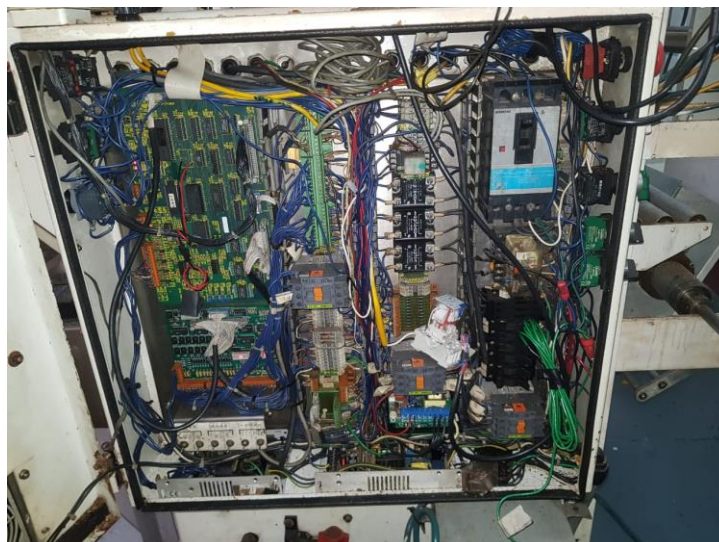
Ilustración 19 Sistema de control actual con PCB
