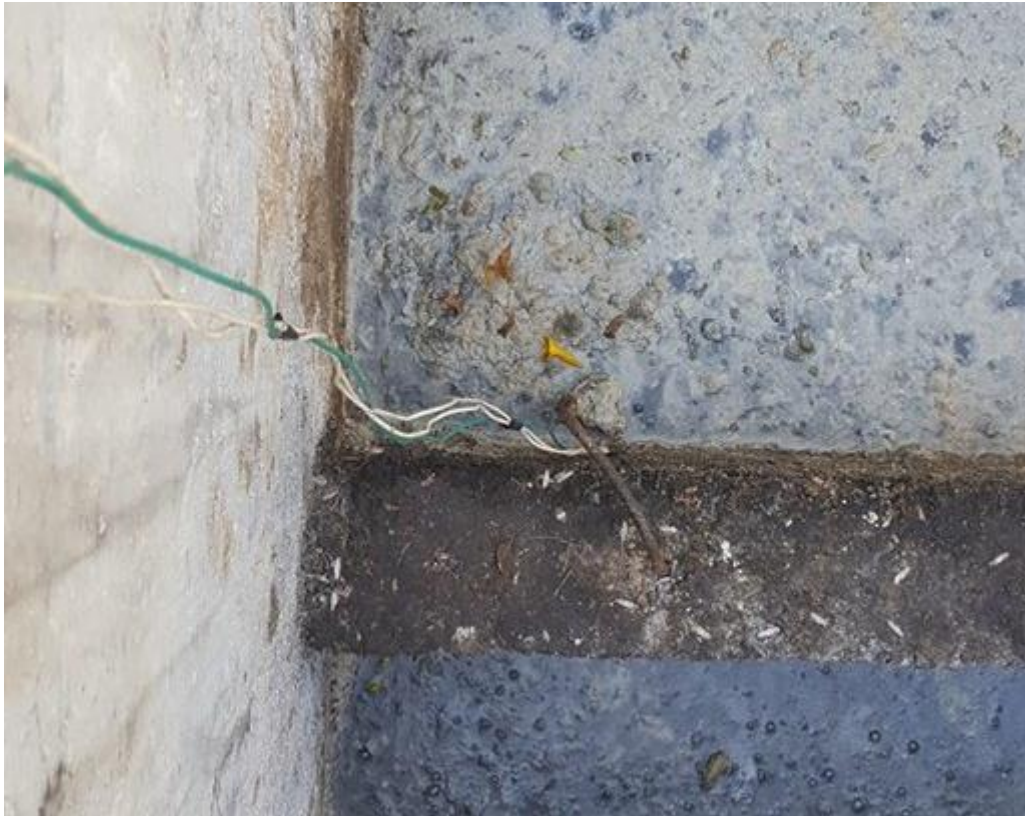
Ilustración 67. Se muestra sensor Pt100 sumergido en la trampa #7
