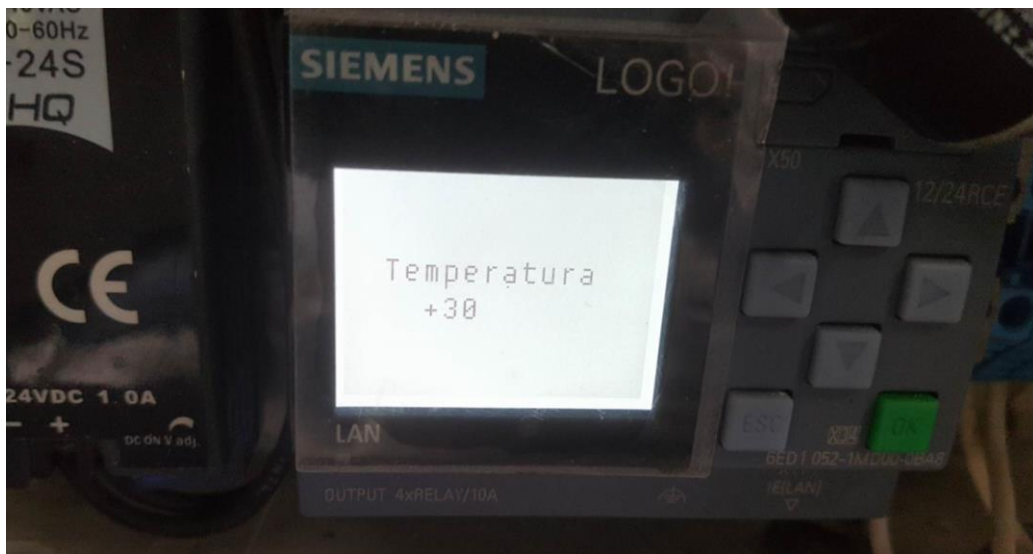
Ilustración 66. Pantalla del logo indicando la temperatura de la trampa #7
