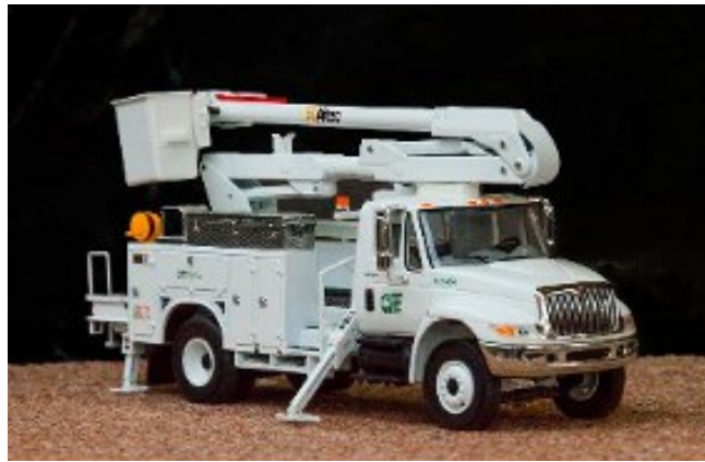
Ilustración 4: Vehículo utilizado para trabajos de mayor altura
