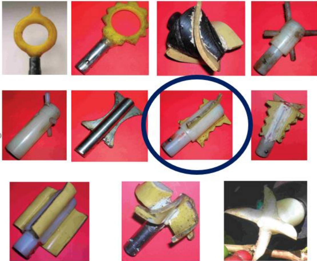
Ilustración 28. Actuadores Evaluados para la Cosecha de Cerezas de Café con el Prototipo ALFA
