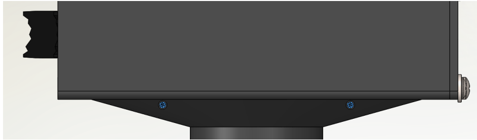
Vista lateral de los agujeros ciegos con los tornillos M3
