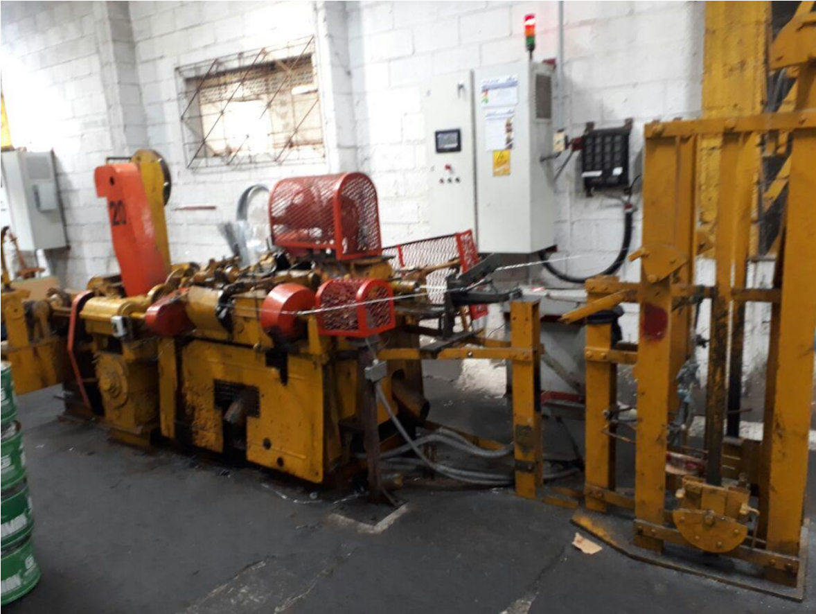
Ilustración 21 Maquina con Servomotor parada ( Torre de Luz en rojo)
