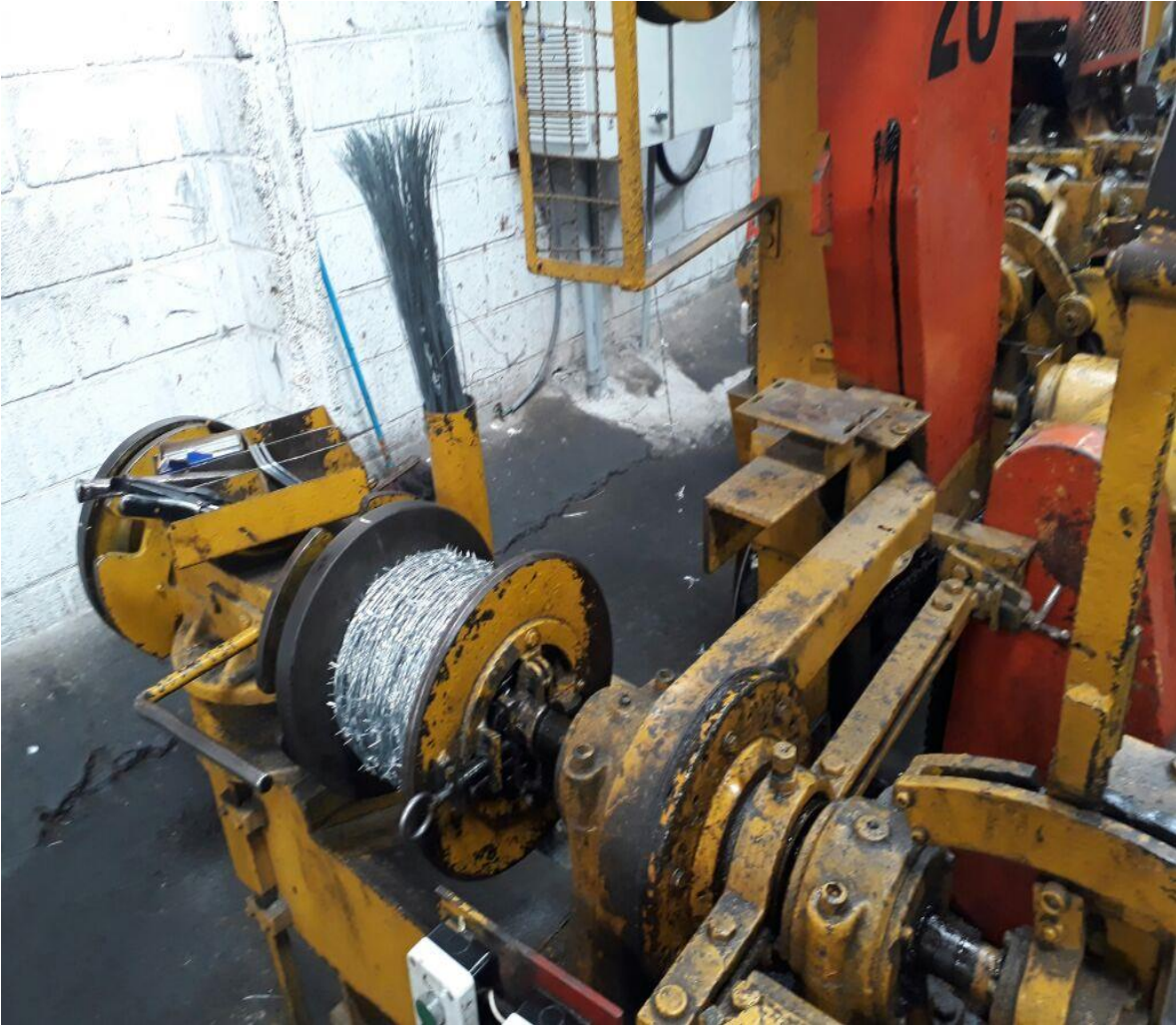
Ilustración 20 Enrollamiento del alambre
