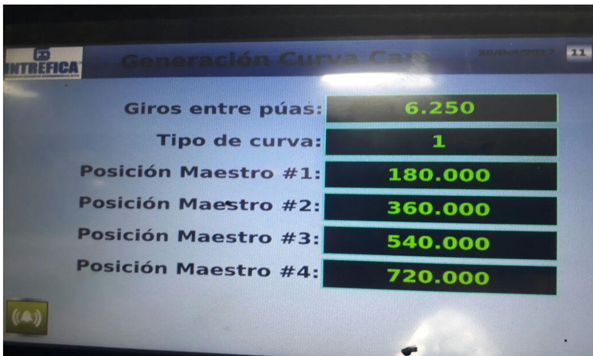
Ilustración 17 Parámetros de giro para el servomotor
