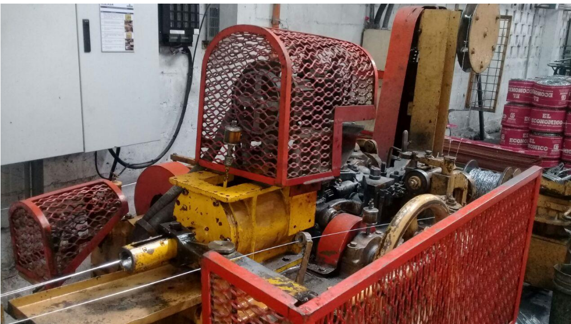
Ilustración 14 Maquina para alambre de púas con servomotor
