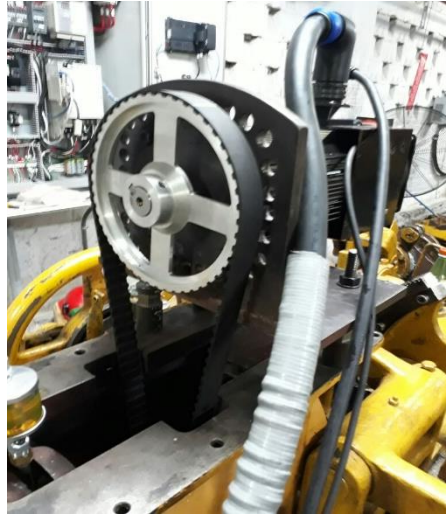
Ilustración 16 Implementación de cambio a Servomotor
