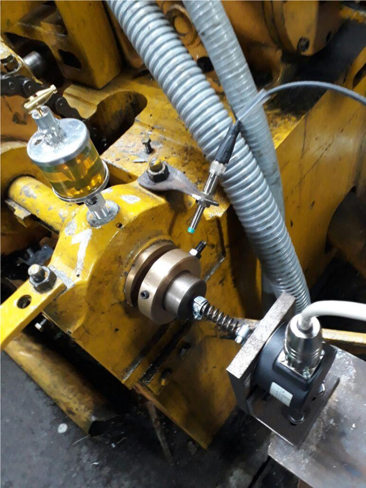
Ilustración 22 Encoder y Sensor Inductivo para indicar la posición 0
