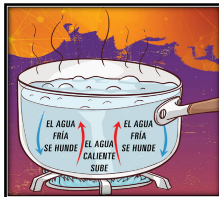
Ilustración 2 - Ejemplo de transferencia de calor por convección.
