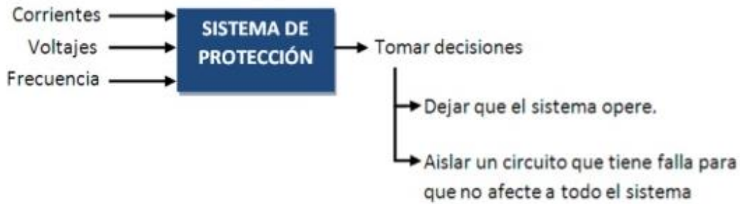
Ilustración 3- Funcionamiento de los relés de protección
