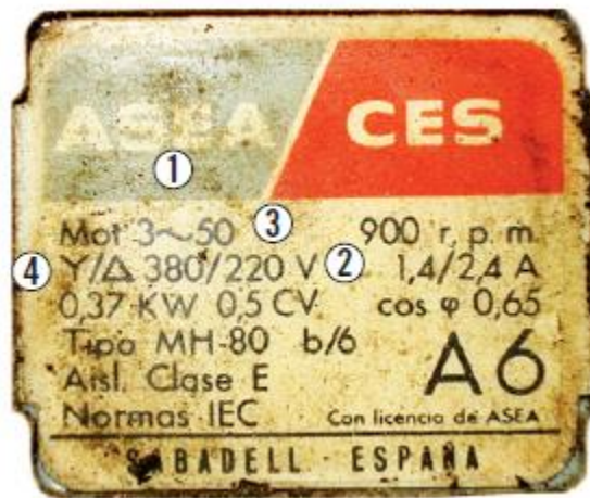
Ilustración 15. Placa característica de un motor
