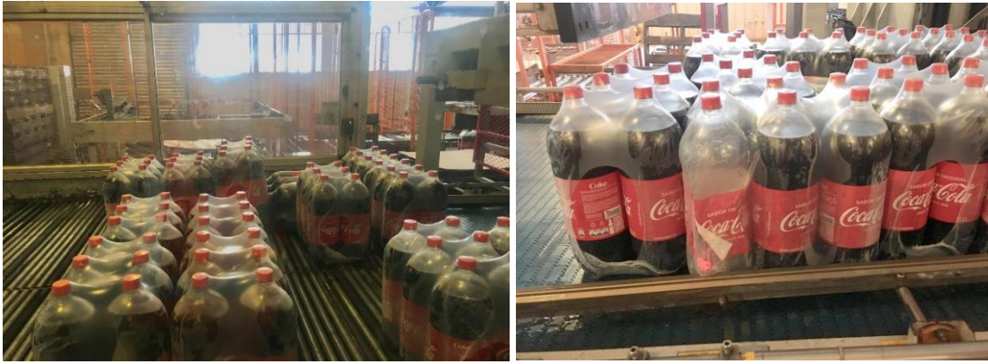
Ilustración 38. Paquete mal Posicionado y Estallado
