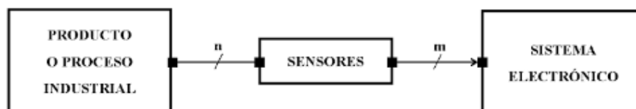
Ilustración 3. Conexión de un proceso industrial a un controlador lógico electrónico.
