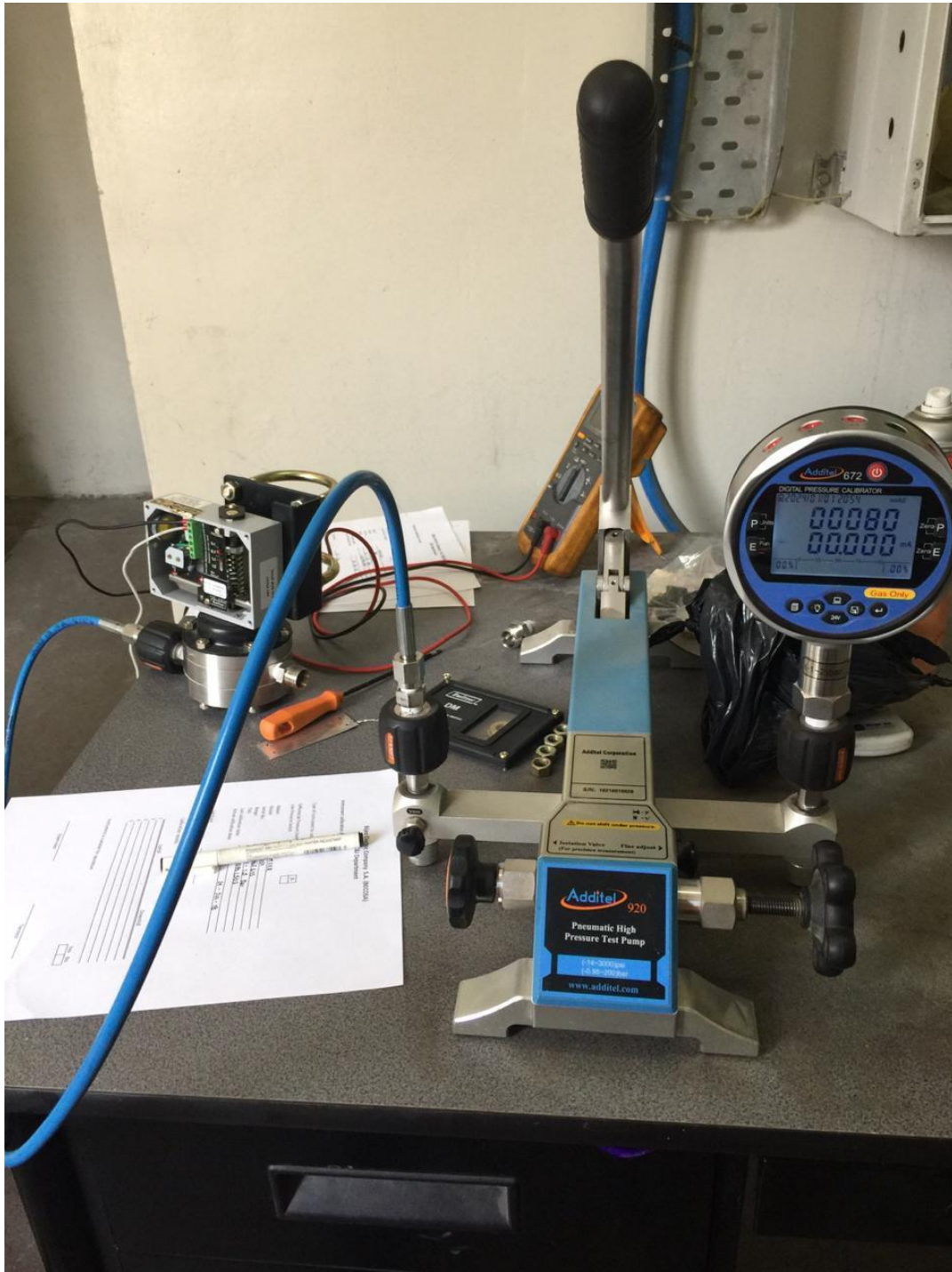
Anexos 21. Montaje para calibración de interruptores de presión
