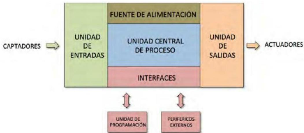
**Ilustración 4. Esquema funcional de un sistema automatizado**
