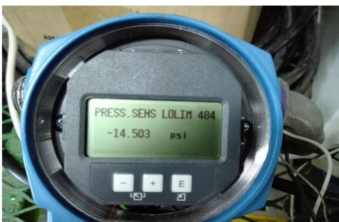
**Ilustración 15. Transmisor de presión Endress+Hauser.**
