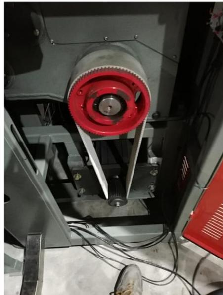
**Ilustración 39** Instalación de servomotor
