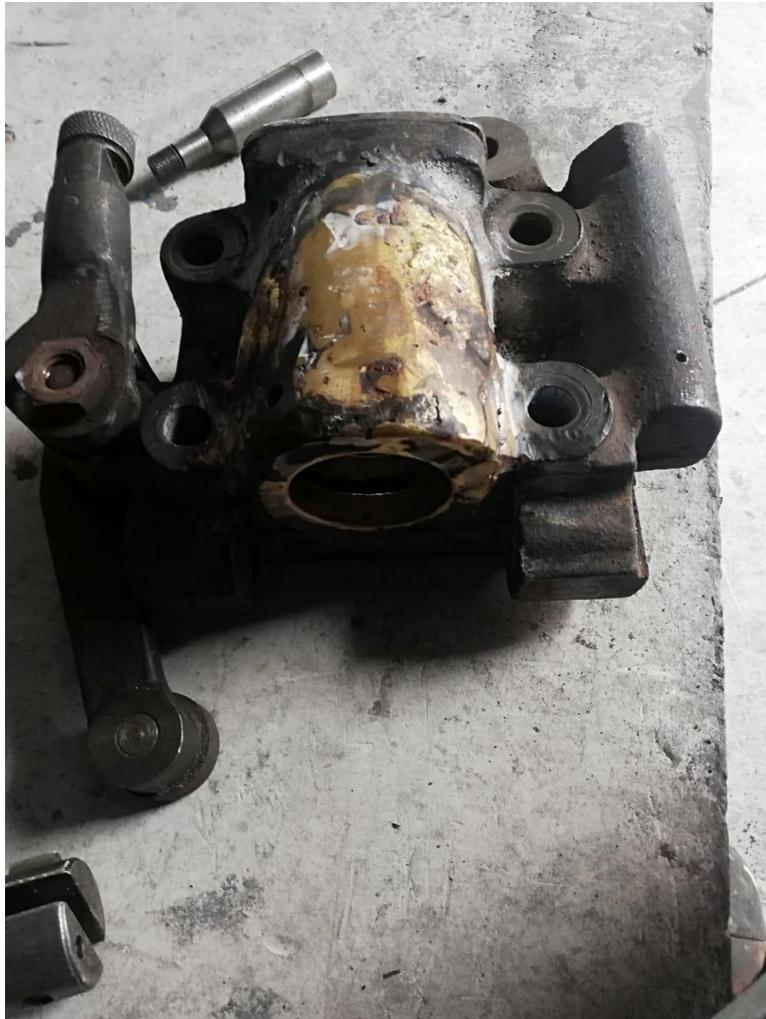
**Ilustración 31**Selector de la transmisión Maquina de Corte
