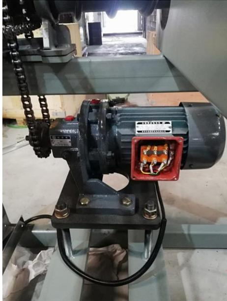
**Ilustración 38** Instalación de motor eléctrico
