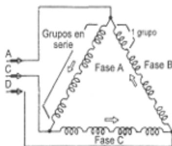
**Ilustración 15** Conexión de motor tipo delta
