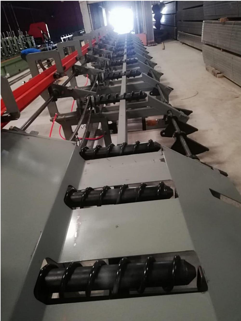
**Ilustración 37 Instalación máquina de varilla**
