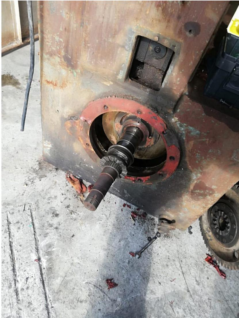
**Ilustración 30 Transmisión de Máquina de Corte desmontada**
