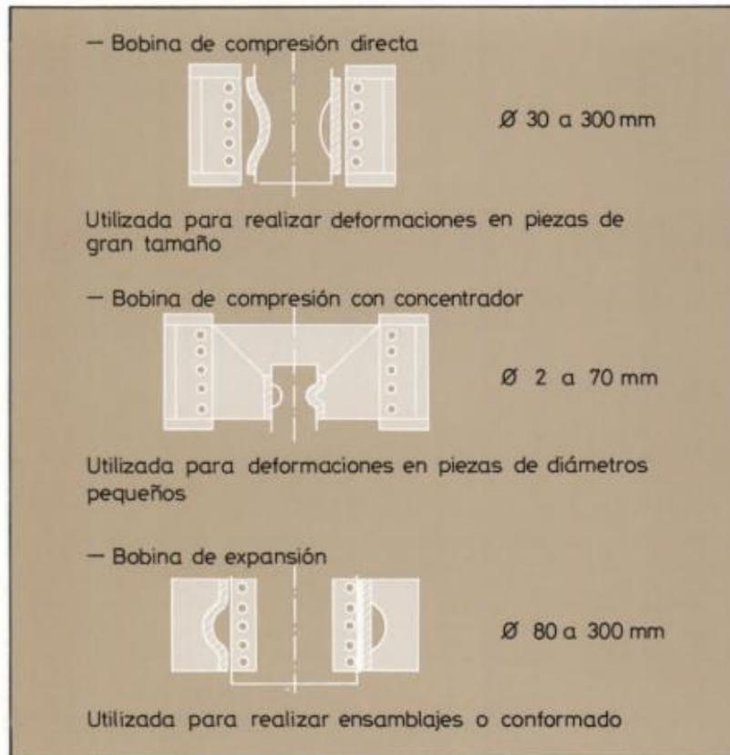
**Ilustración 7 Bobinas utilizadas en la magnetohechura**
