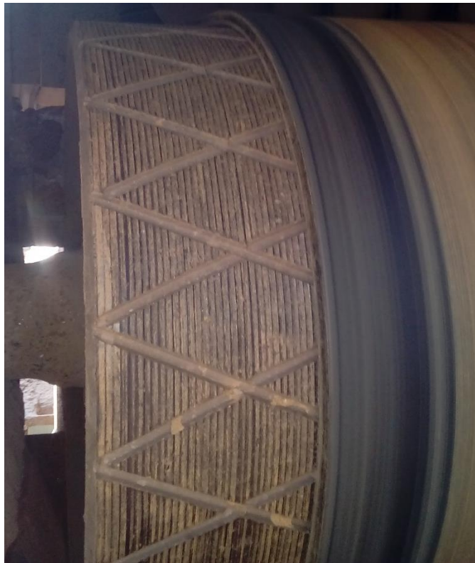
Anexo5. Rodo motriz de banda transportadora con caucho en buen estado.
