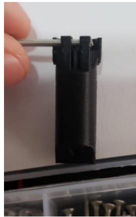
Ilustración 39. Acople tornillos de 2mm a las falanges
