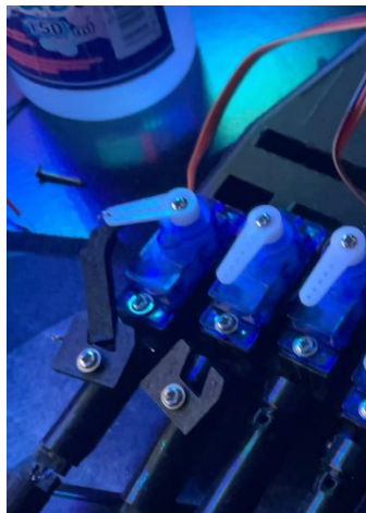
Ilustración 29. Ensamblaje de mecanismo para accionamiento de dedos
