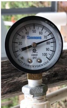
Ilustración 36. Presión de funcionamiento.
