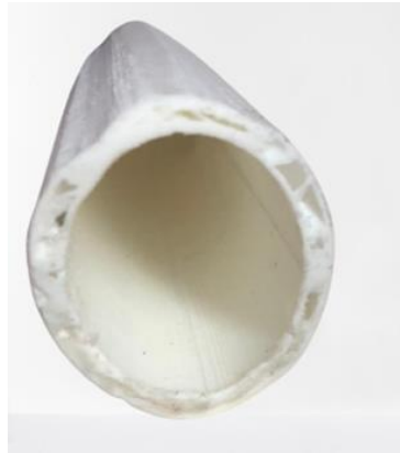
Figura 35-Ducto de semillas con diámetro de 4cm
