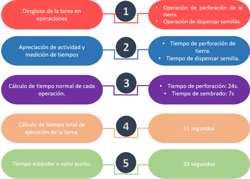
Figura 16- Etapas de tiempos y movimientos del efector final de siembra.
