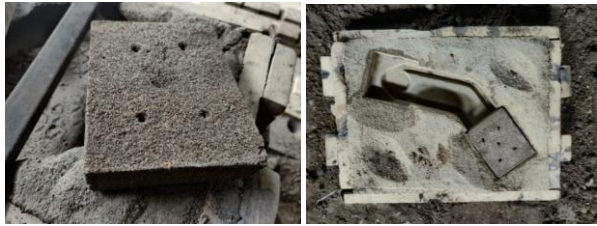
Figura 35: Huecos en Extremos del Fémur con Bloques de Bentonita y Arena
