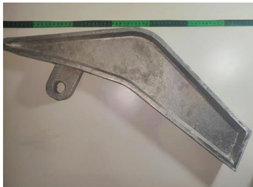
Figura 39: Fundición Final de Tibia en Aluminio
