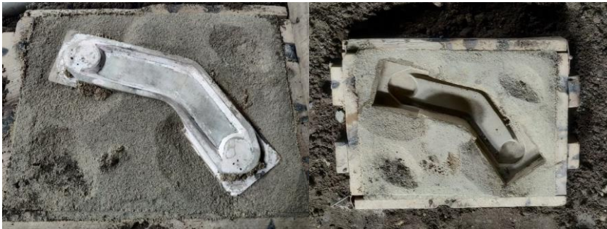
Figura 36: Moldes de Arena para Fundición de Fémur
