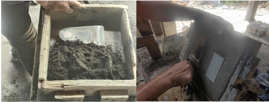
Figura 37: Proceso de Creación de Moldes de Coxis y Soporte de Coxis
