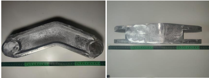
Figura 38: Fundición Final de Fémur en Aluminio
