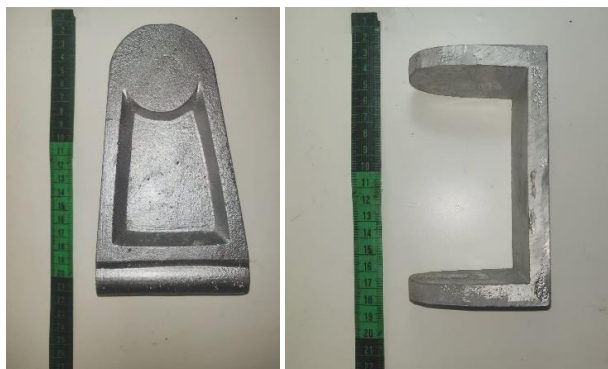
Figura 40: Fundición Final de Coxis y Soporte de Coxis en Aluminio
