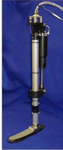
Ilustración 21. Prototipo de prótesis transfemoral motorizada.
