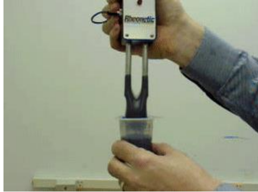
Ilustración 29. Fluido MR pasando de semisólido a fluido.
