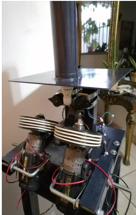
Figura 44. Integración de Todas de Actuadores de Lanzamiento y Agarre
