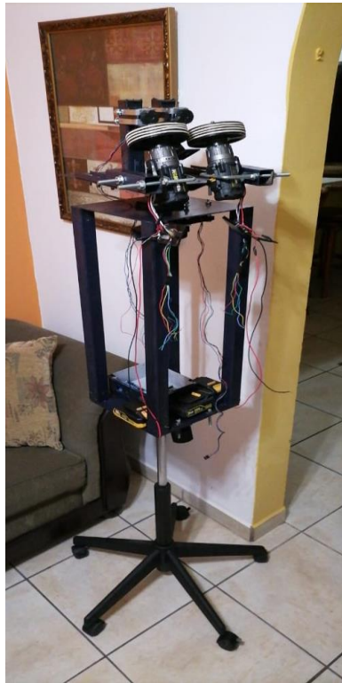
Figura 28. Estructura y Actuator de Lanzamiento fabricado Completamente
