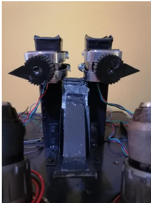
Figura 31. Actuador de Agarre y Transporte de Volante
