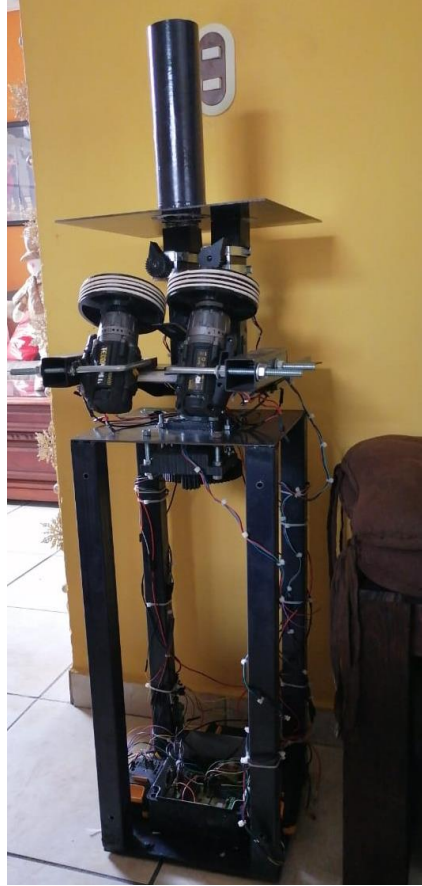
Figura 45. Integración de Todas las Partes Mecánicas del Robot
