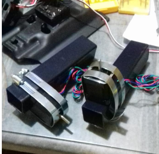
Figura 29. Tubo Estructural Junto a Motores Stepper de Sistema de Agarre
