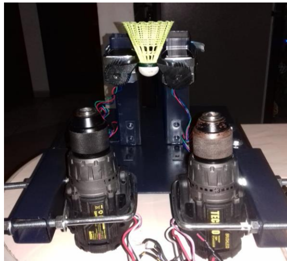
Figura 30. Sistema de Agarre Junto a Motores Sin Escobillas
