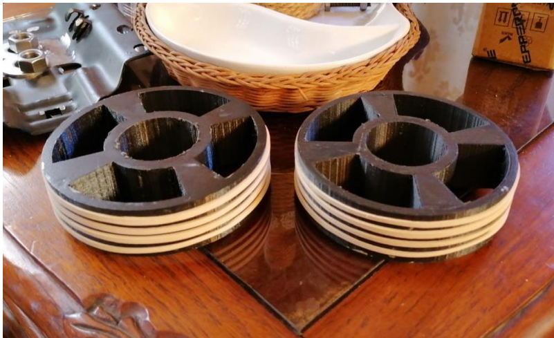
Figura 32. Ruedas Impresas para Actuador de Lanzamiento
