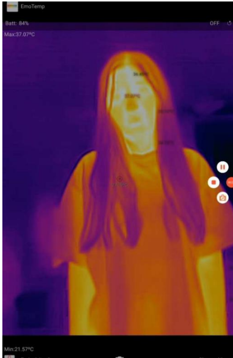
Ilustración 12 Ejemplo de búsqueda automática de los puntos con mayor temperatura. Advertencia cuando un valor está por encima del umbral de temperatura establecido.
