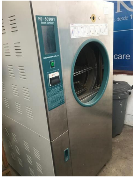
Ilustración 27. Esterilizador a vapor Hanshin, HS-5020PT
