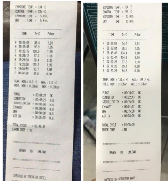
Ilustración 29. Pruebas de funcionamiento de esterilizando HS-5020PT
