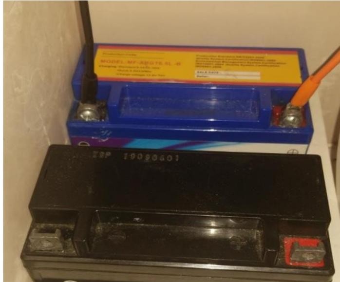
**Ilustración 65 baterías de gel de 12v. Fuente: Propio**
