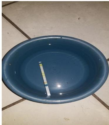
**Ilustración 32 Tira reactiva insertada en el agua midiendo el pH. Fuente: Propio.**
