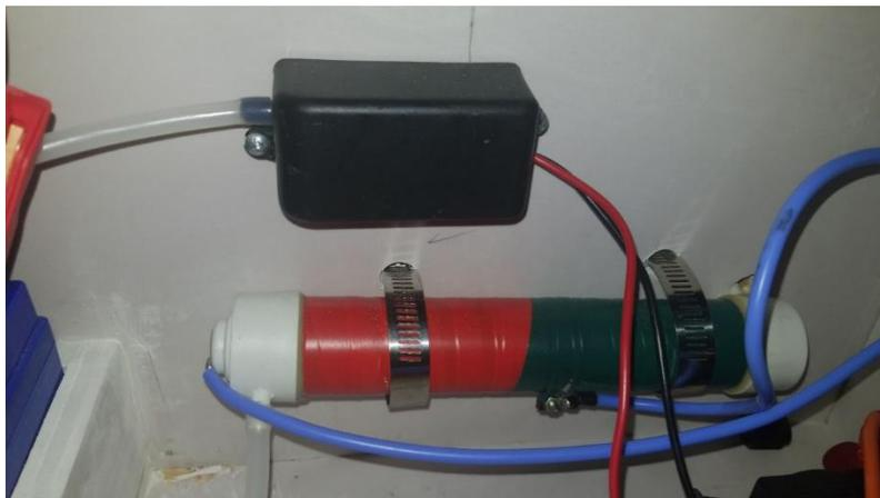
**Ilustración 24 Reactor y bomba de aire conectados al transformador.**
