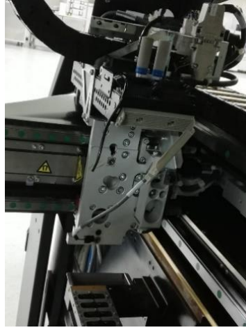
Ilustración 14. Desmontaje de las cámaras.
