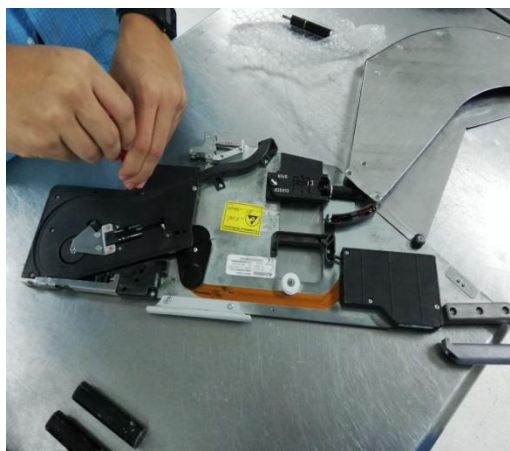
Ilustración 37. Cambio de motor al feeder
