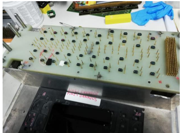
Ilustración 57. Fixtura de ICT.
