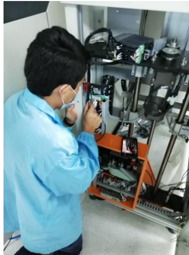
Ilustración 26. Proceso de cableado del Buffer.
