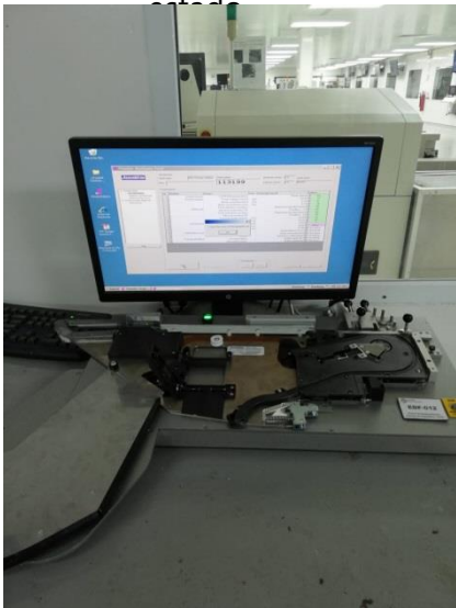
Ilustración 45. Área de diagnóstico de los feeders.
