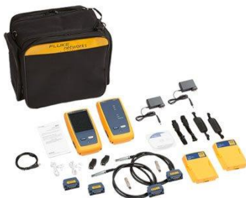
Ilustración 26. Certificador Fluke DSX 5000
