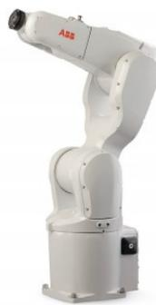
Ilustración 38 Robot 6-GDL ABB IBR1200 5-90
