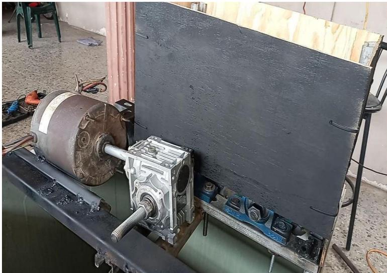
**Fig.19-Motor acoplado a caja reductora de velocidad.**
