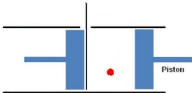
Ilustración 3. Motor de Szilard comprimido hacia la derecha.
