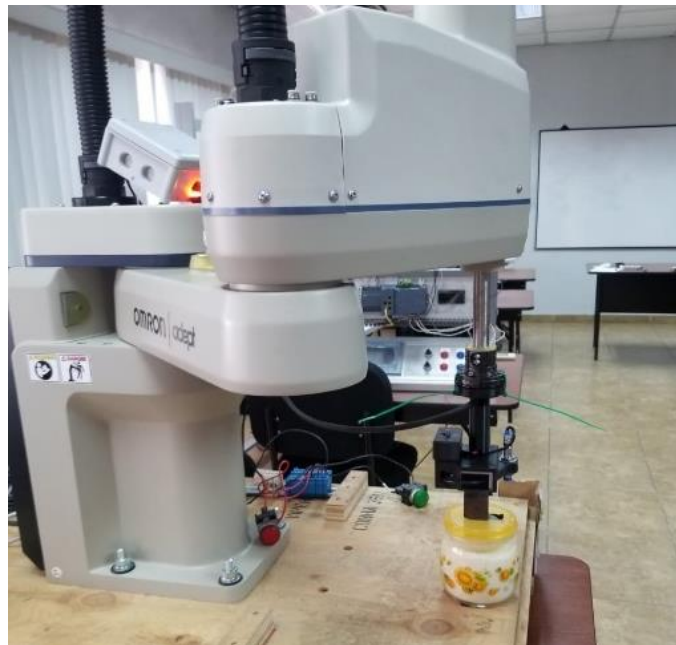
Ilustración 22: Efector final magnético en Cobra
