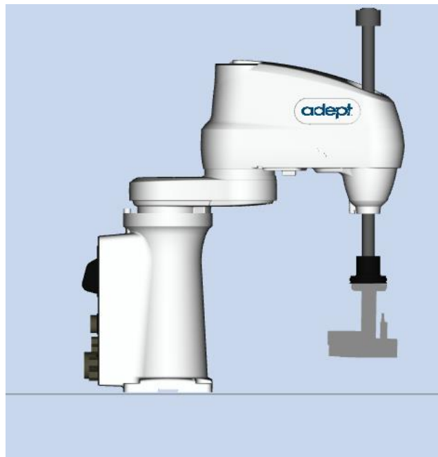
Ilustración 20: Efecto final magnético en Cobra 650 ACE
