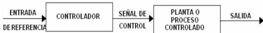
Ilustración 14-Diagrama de bloque de un sistema de lazo abierto
