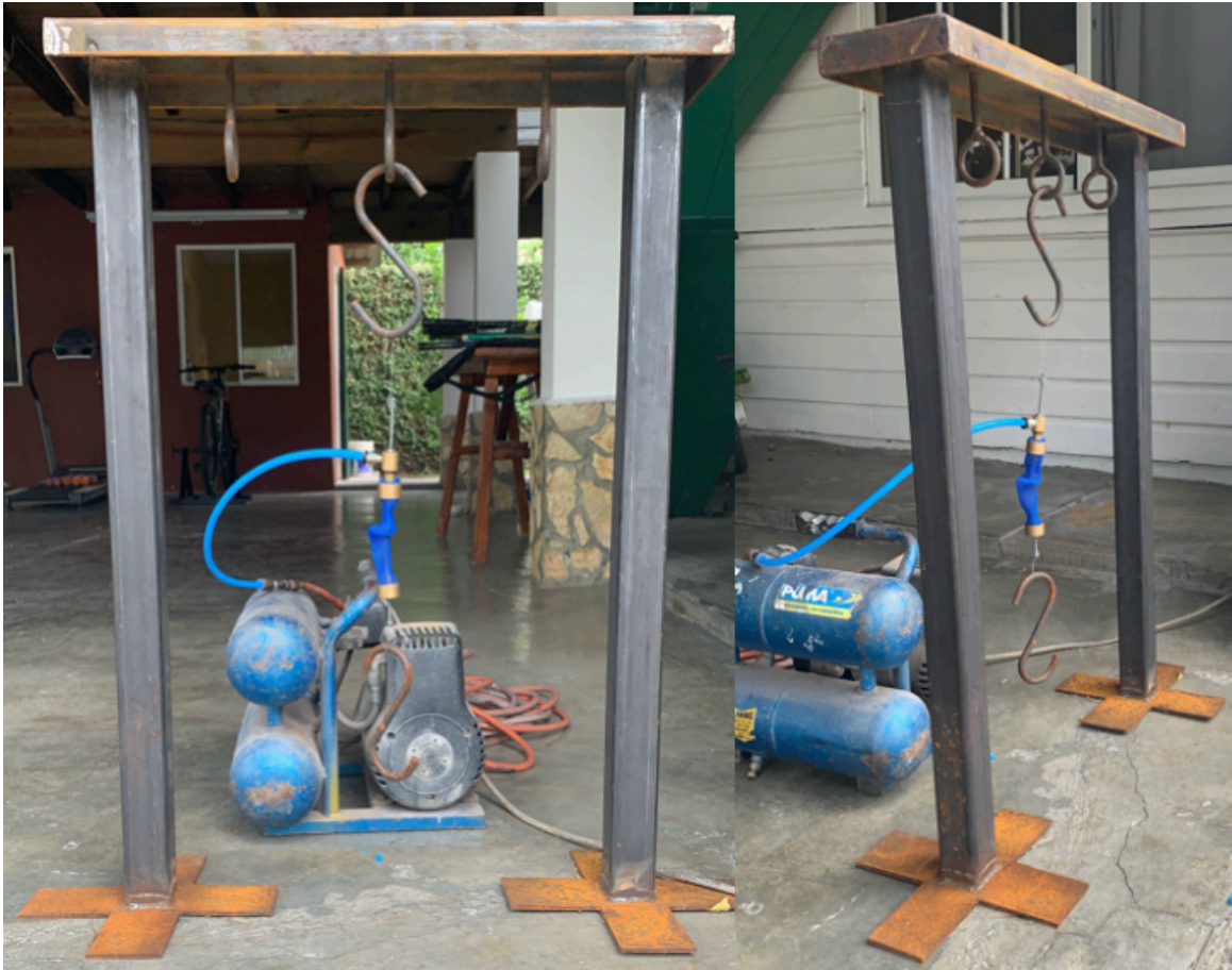
Ilustración 32: Músculo Neumático de una Manguera Instalado en el Banco de Pruebas de Hierro
