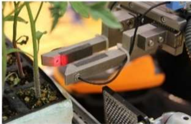
Ilustración 24. Gripper de agarre de plántula para injertos
