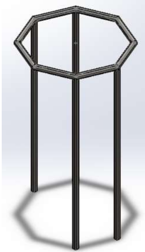
Ilustración 40. Base estructural sin refuerzos diagonales
