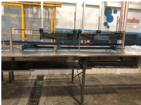
Como se observa en la ilustración, se instaló una estación de salida de lata con sus canales que desvían su curso hacia la estación, donde los auxiliares estarán preparando los paquetes de 24 unidades.
